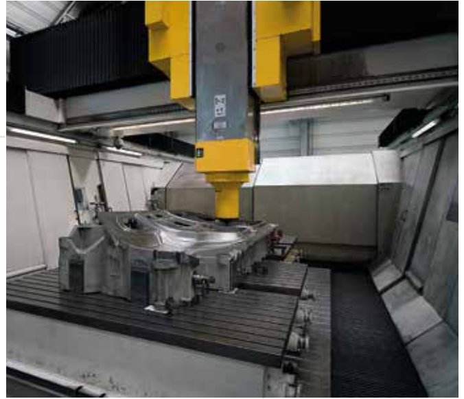
Fräsbearbeitung Seitenwand außen
