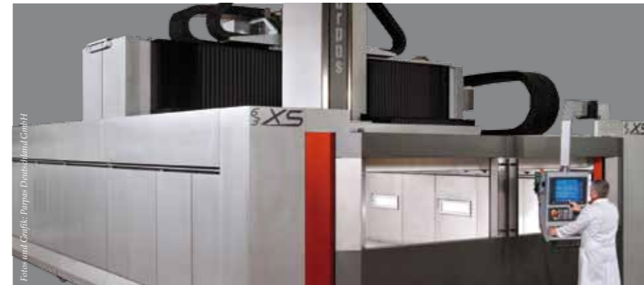
Der Aufbau der Parpas XS Gantry besteht aus fünf Strukturteilen.
