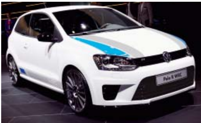
Die Motorhaube des VW Polo R WRC ist aus dem Stahl-Kunststoff-Sandwich Litecor von ThyssenKrupp und erhielt dafür den 1. Innovationspreis SPE CE 2015 in der Kategorie „Außenteile“. Bild: VW
