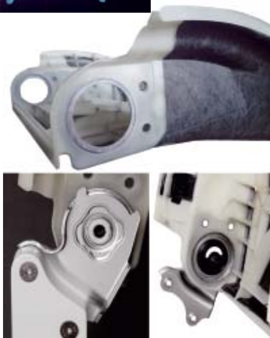
Von der vorne gezeigten Hybrid-Sitzlehne ist hier auch die Rückseite zu sehen. Erfolgsmeldung: der Pkw-Sitz spart mehr als 40 % Gewicht ein. Das Bild daneben zeigt den Bereich des Metalleinsatzes, vor und nach der Montage. Bilder: JCI
