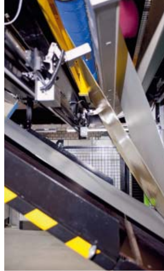
Produktion von Stahlblechen mit Kunststoffkern: ThyssenKrupp sieht „Litecor“ als vielversprechenden Leichtbauwerkstoff für den Automobilbau an. Bild: ThyssenKrupp
