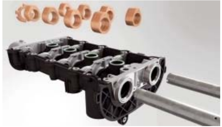
Im Projekt InCar Plus wurde unter anderem dieses Zylinderkopf-Hauptmodul entwickelt, das Aluminium-, Stahl- und Polymerwerkstoffe kombiniert. Gegenüber einer Vollaluminium-Version senkt es das Gewicht um 15 %. Bild: ThyssenKrupp-Video
